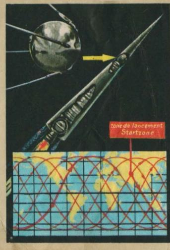
**Le Sputnik I et son orbite.** - Dans la nuit du 4 octobre 1957 les Russes ont lancé le premier satellite artificiel, une boule de 58 cm de diamètre, à l'aide d'une fusée simplifiée, mais d'une grande puissance.
